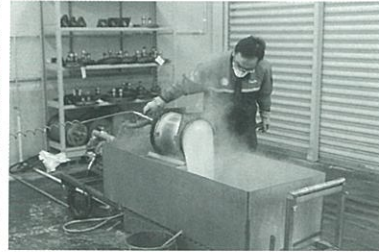
マフラーの洗浄作業
